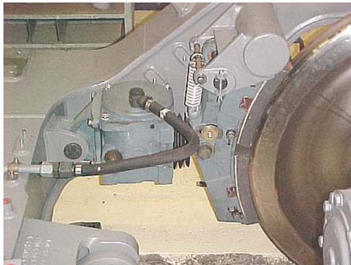
Bloc de freinage compact avec semelle composite double sur roue motrice d'automoteur TER X 72500
