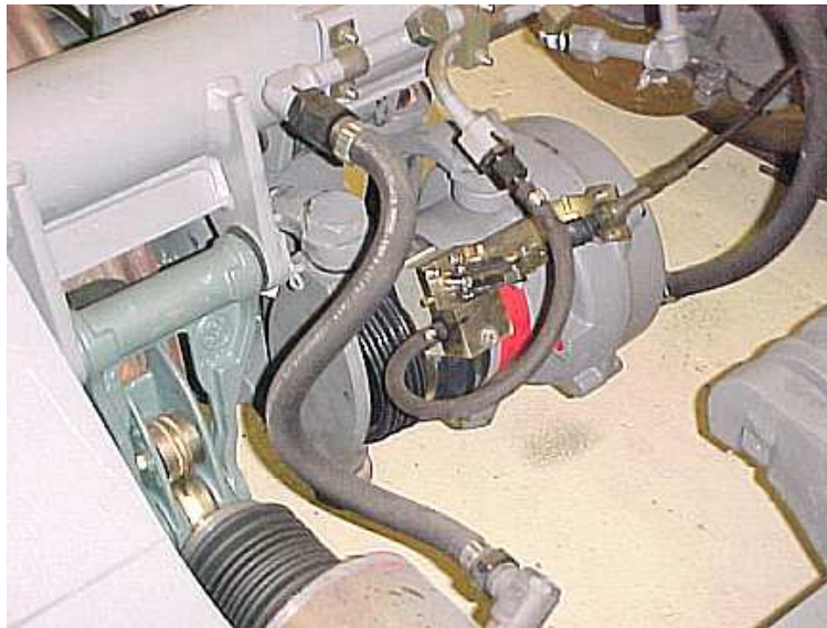
Cylindre de frein à disque avec frein de parking intégré sur essieu porteur d'automoteur TER X 72500 (avec dispositif de déverrouillage par câble)
